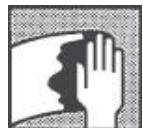
enlever toute la rouille (s'il y a lieu), poncer la surface, bien nettoyer la surface avec le décapant silicone SprayMax®, produit n° 3 680 090; il ne doit pas y avoir de graisse, poussière et humidité sur la surface. Agiter vigoureusement le contenant aérosol durant 2 min., vaporiser pour tester le produit.
