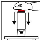
Placer l'aérosol muni du capuchon sur un support fixe, tête en haut. Appuyer à fond avec la main sur le percuteur rouge.
