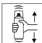
Après remplissage de l'aérosol et avant le déclenchement, bien agiter pendant 2 minutes à compter du bruit clair des billes mélangeuse.
