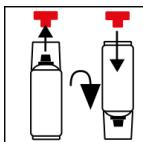
Retirer le percuteur rouge du capuchon. Tourner l'aérosol à 180° et placer le percuteur sur la tige située à la base de l'aérosol.
