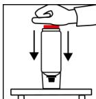
Placer l'aérosol muni du capuchon sur un support fixe, tête en haut. Appuyer à fond avec la main sur le percuteur rouge.
